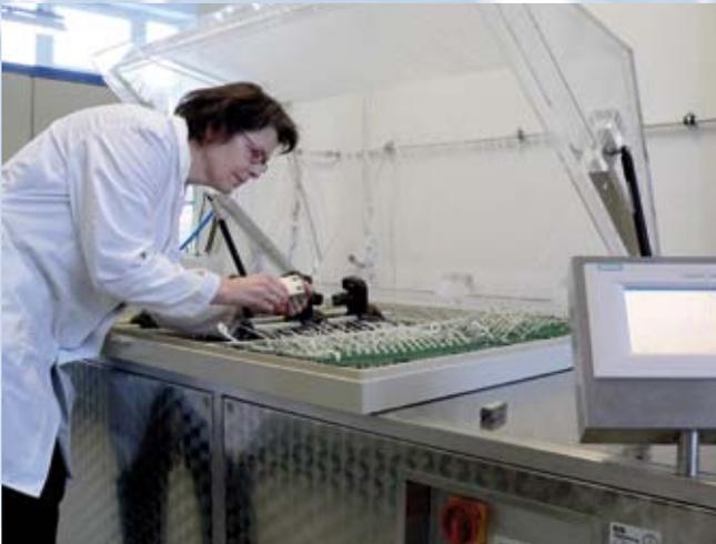
Zwischenbeurteilungen bei Korrosionsprüfungen
