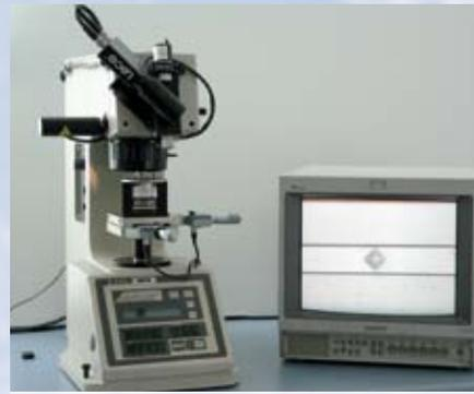
Mikrohärteprüfgerät mit Monitor
